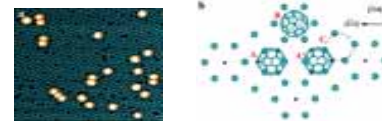
(a) 0.05亚单层C60分子吸附在Si(111)-7×7表面的STM图象(25×25 nm²) (b) C60在Si(111)-7×7单胞中的吸附位置示意图
