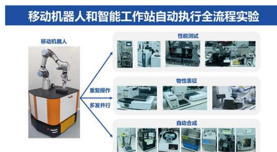
图注：移动机器人和智能工作站完成高通量合成、表征、测试的化学实验全流程
